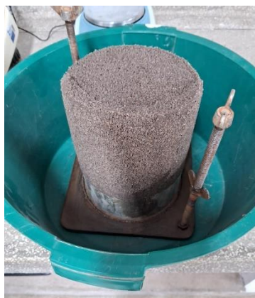
Figura 7 – Corpo de prova compactado desprendido do cilindro no momento da inversão para o ensaio CBR.
