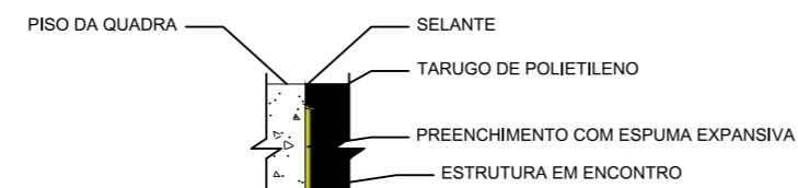
7 DETALHE - SELAMENTO DE JUNTAS DE ENCONTRO ESCALA 1:10
